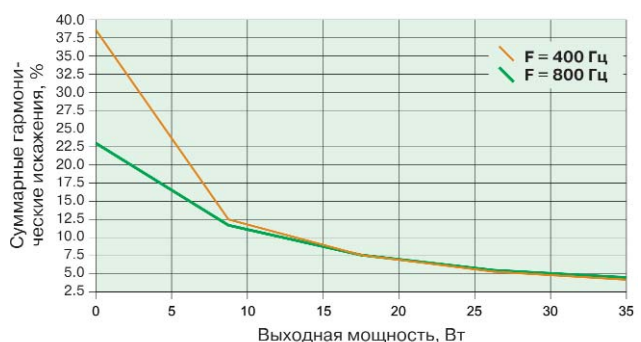
Рис. 2. Зависимость гармонических искажений от выходной мощности и частоты сетевого напряжения
